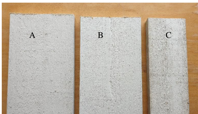
Figur 1. Målade fasadbrädor. (A) Exponerad på försöksfält (Akrylat), (B) Exponerad på försöksfält (Alkyd), (C) Från takutsprång på garage (Okänt färgsystem)
