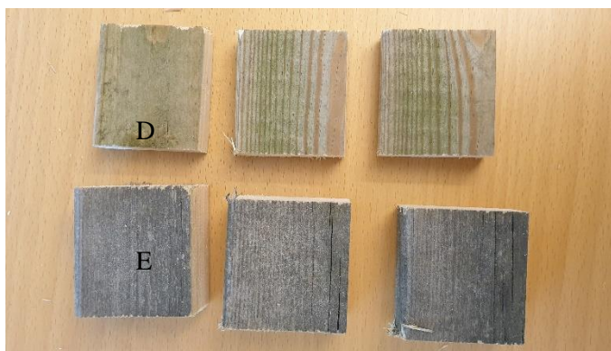
Figur 4 Prover från de två impregnerade brädorna för provning av en produkt. D kommer från byggvaruhandelslager, E från altan. Från varje bräda och produkter användes ett prov för klimatkammare och två för att prova avdödning av mögel respektive alger.
