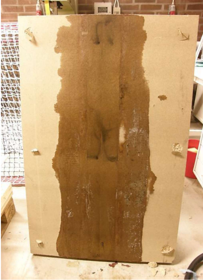
Fotografi 13. Kraftigt läckage på undersida provlåda.
