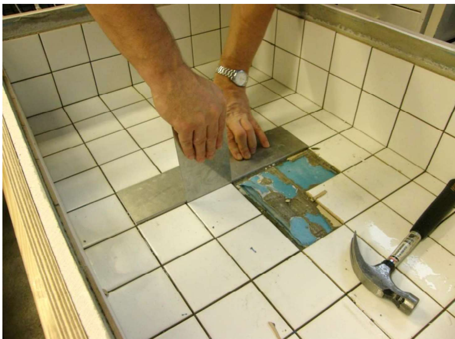
Fotografi 2. Borttagning av kakelplattor i provlåda 1.
