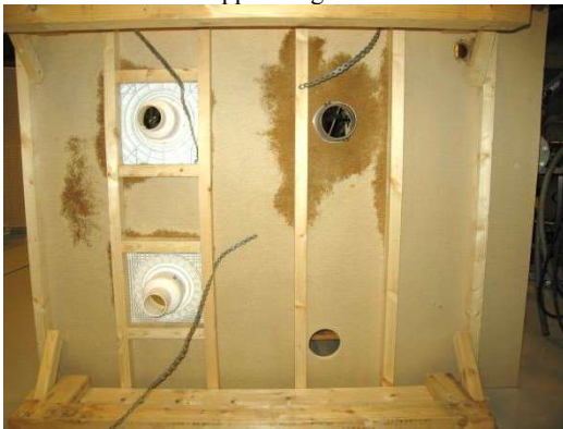
Blöta partier på lådans undersida.
