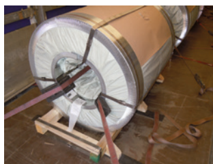
Använd kantskydd för att skydda spännband eller gods.
