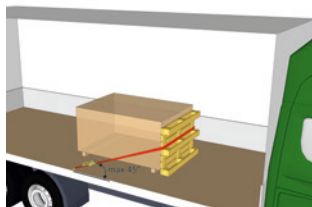
Vinkeln mellan surrningen och lastplan ska vara max 45°.
